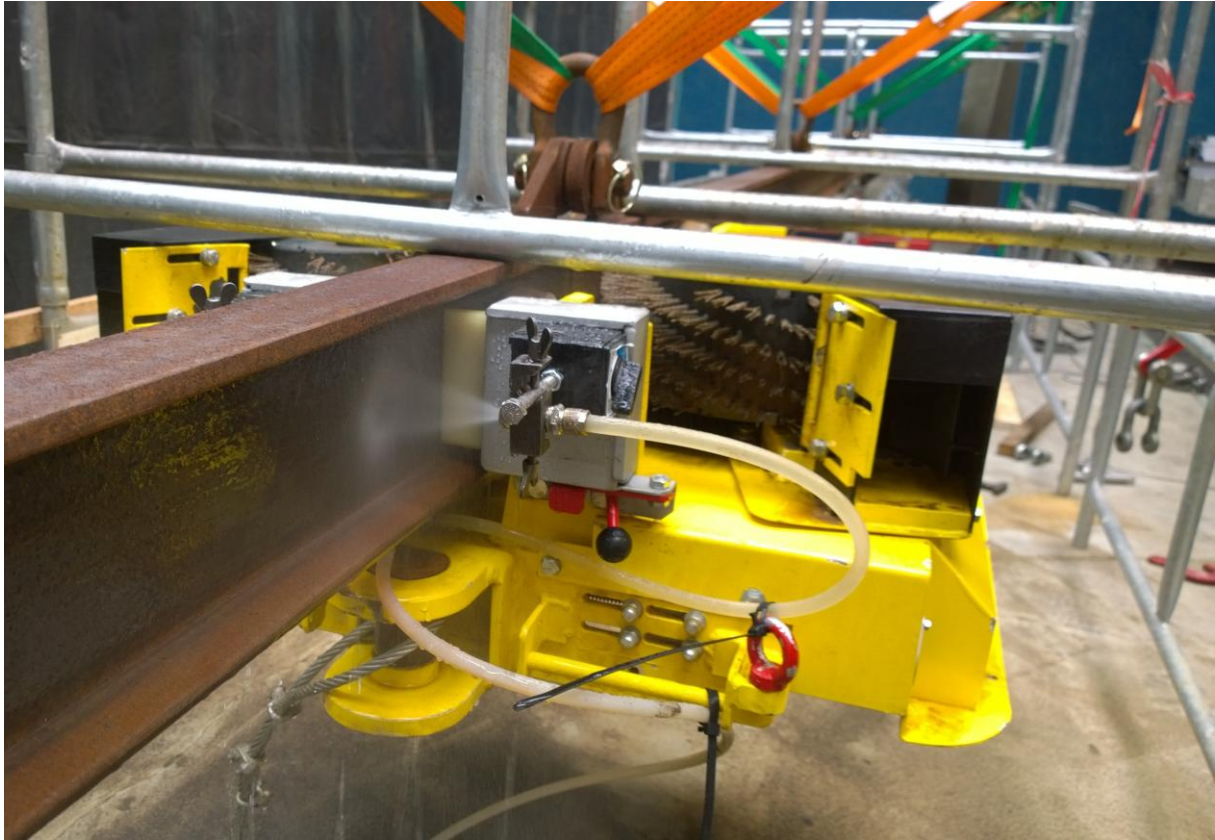
Rys. 7. Czyszczenie szyny z wodnej mieszaniny pyłu węglowego i kamiennego szczotkami wspomaganymi wodą [2]
