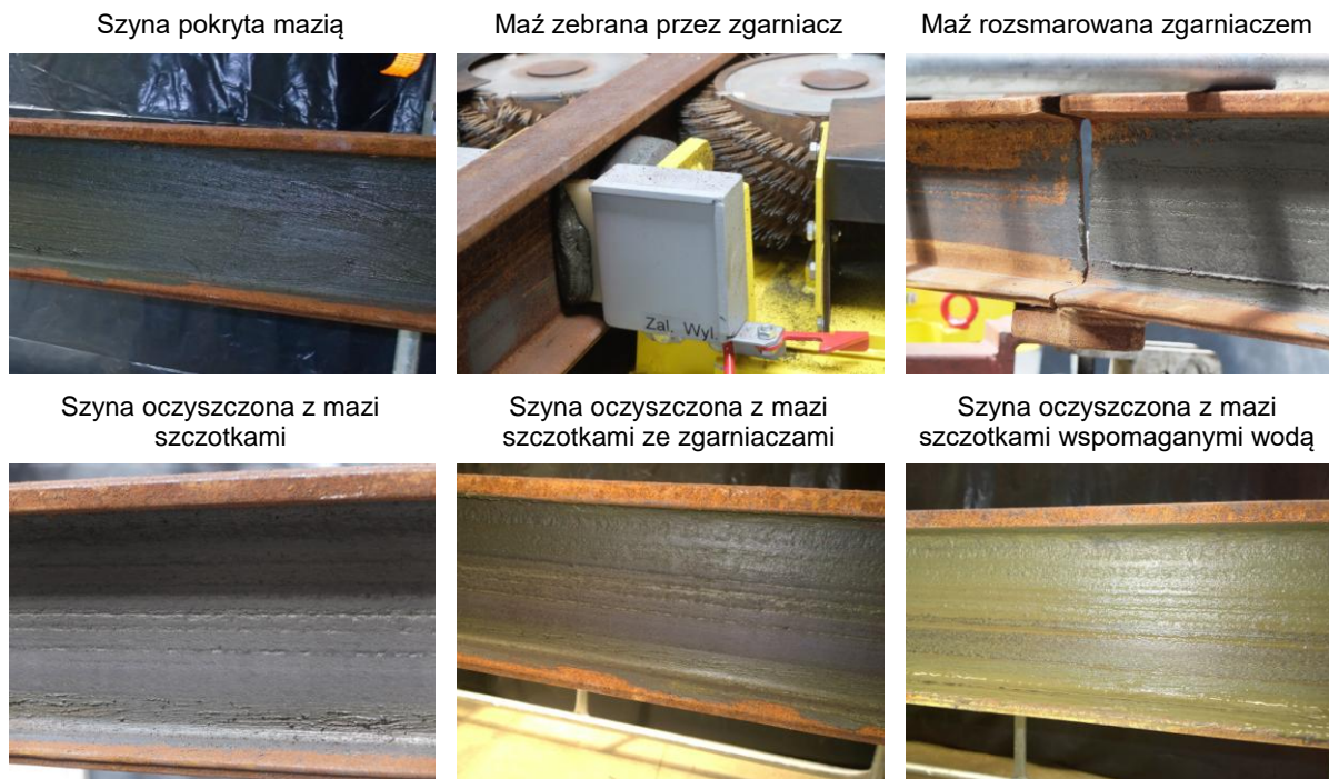
Rys. 6. Efekty wizualne czyszczenia szyn z wodnej mieszaniny pyłu węglowego i kamiennego [2]
